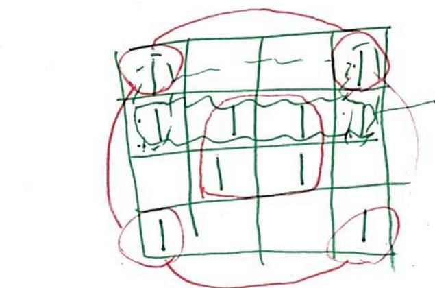
$$F_2 = \overline{B}\overline{D} + BD + \overline{AB} + \overline{AD}$$
